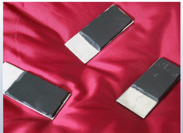
135°C x 70hrのスチーム暴露後のAFLAS®破断状態
